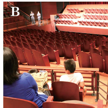
森のホールは舞台と客席が、一部が可動式になっており、利用目的に応じて舞台にしたり、客席にしたりできます。また、下がることによって奈落へと降りることもできます。AとBの写真は、舞台が回転し客席へと変わるところを、Cの写真は下がっているところを写したものです。
