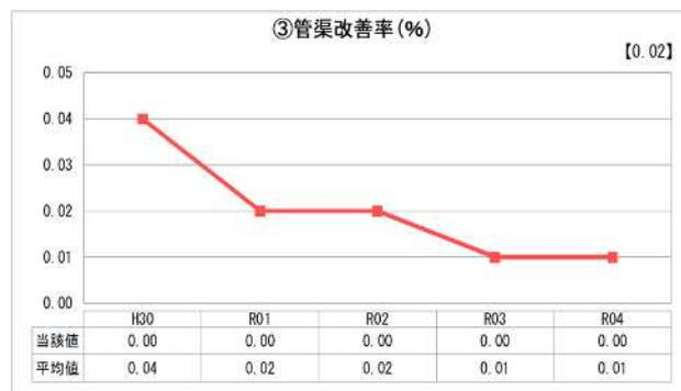
$$\text{管渠改善率} = \text{改善（更新・改良・修繕）管渠延長} / \text{下水道布設延長} \times 100$$
