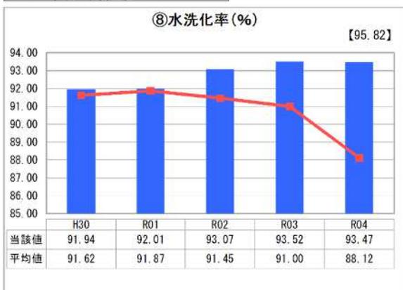
$$\text{水洗化率} = \text{現在水洗便所設置済人口} / \text{現在処理区域内人口} \times 100$$
