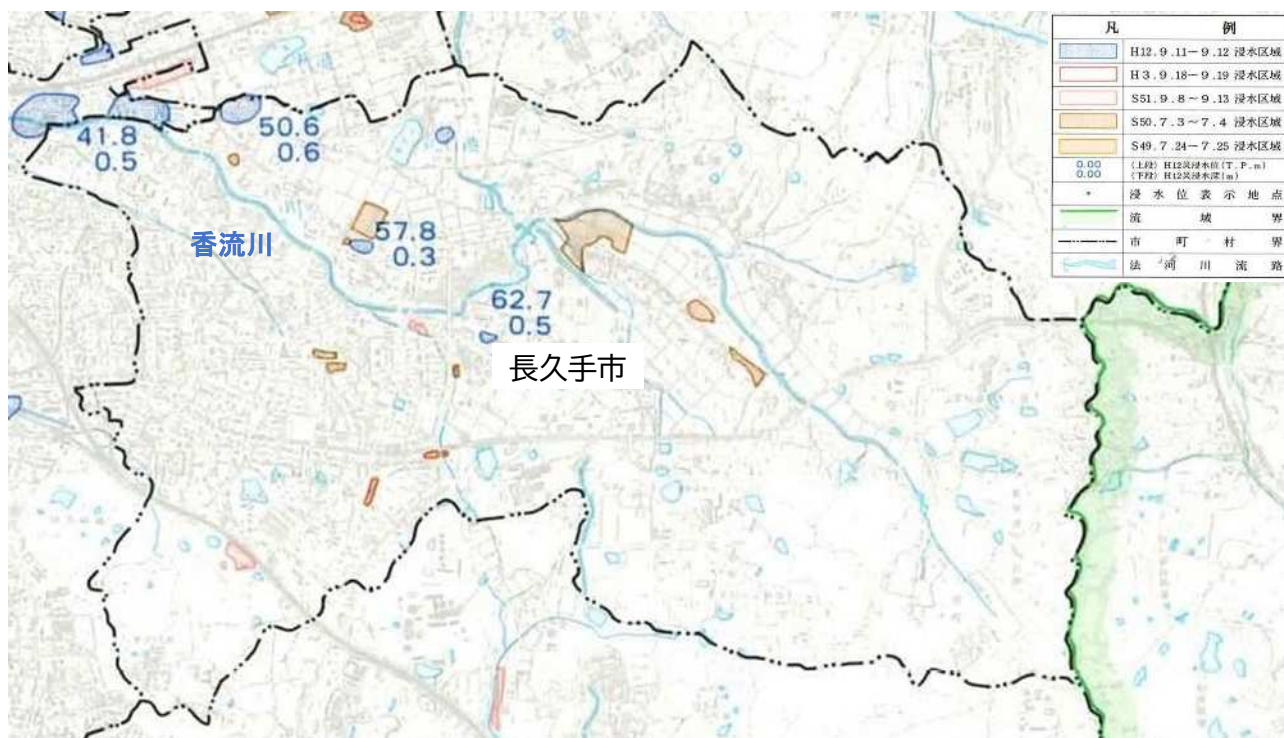
図：浸水実績（昭和49年7月豪雨、昭和50年7月豪雨、昭和51年9月豪雨、平成3年9月台風18号、平成12年9月豪雨（矢田川・内津川・八田川・堀川・天白川・山崎川・郷瀬川流域） （資料：愛知県浸水実績図）
