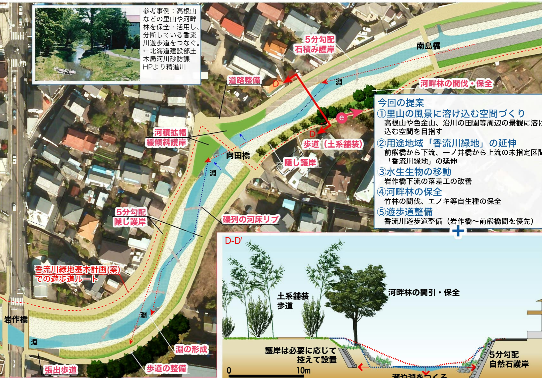
香流川整備基本構想 (H24)時は鬱蒼としていた竹林が間伐され管理道路 (土系) が整備されている
