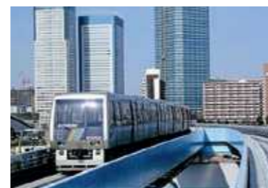
新交通システム「ゆりかもめ」 ゴムタイヤ車両が軌道上を走行する。 (桃花台線、ゆりかもめ)
