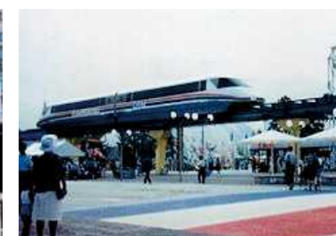
磁気浮上式システム「横浜博覧会場」 電磁石で浮上し、リニアモーターで走行(リニモ)
