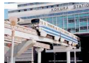
跨座式モノレール「北九州モノレール」 一本の桁を軌道として走行する。 (東京モノレール、北九州モノレール)
