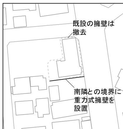
図 37 既設の擁壁の撤去と新たな擁壁の築造
